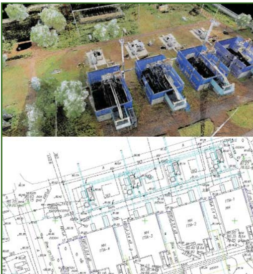
Рис. 2 Облако точек (вверху) и построенный по нему топографический план масштаба 1:500 (внизу)
